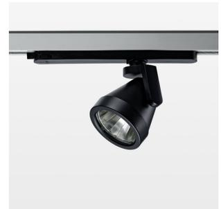
Aufbauleuchte mit LED, Bemessungslebensdauer der LED L80/B10 50000 h (Tambient 25°C), Farbwiedergabeindex CRI > 80, Farborttoleranz 2 SDCM (initial), rotationssymmetrischer Reflektor mit kreisförmigen Lichtbild, Reflektor Reinstaluminium 99,99% in MIRO-Silver®, Leuchtenkopf/Halteam Aluminium-Druckguss, pulverbeschichtet, schwarz, Drehwinkel 330°, Schwenkwinkel +/- 85°, In-Track-Adapter, On/Off, 220-240 V~ / 50-60 Hz, max. Anzahl Leuchten pro Stromkreis 27 Stk. / B16A
