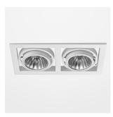
Einbauleuchte mit LED, Bemessungslebensdauer der LED L80/B10 > 50000 h, Farbwiedergabeindex CRI > 90, Farborttoleranz 2 SDCM (initial), rotationssymmetrischer Reflektor mit kreisförmigen Lichtbild, Schwenkwinkel +/- 30°, Leuchtengehäuse Stahlblech, pulverbeschichtet Weiss, separate Treibereinheit
