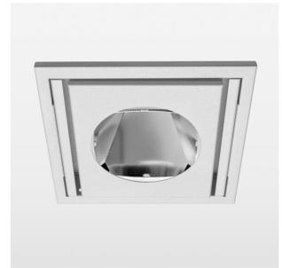
Einbauleuchte mit LED, Bemessungslebensdauer der LED L80/B10 > 50000 h, Farbwiedergabeindex CRI > 80, Farborttoleranz 3 SDCM (initial), Reflektor mit kreisförmigem Lichtbild, Schwenkwinkel 30°, Leuchtgehäuse Stahlblech, pulverbeschichtet Weiss, separate Treibereinheit
