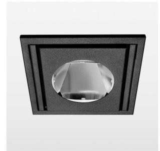
Einbauleuchte mit LED, Bemessungslebensdauer der LED L80/B10 > 50000 h, Farbwiedergabeindex CRI > 80, Farborttoleranz 2 SDCM (initial), Reflektor mit kreisförmigem Lichtbild, Schwenkwinkel 30°, Leuchtgehäuse Stahlblech, pulverbeschichtet schwarz, separate Treibereinheit
