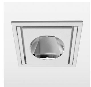
Einbauleuchte mit LED, Bemessungslebensdauer der LED L80/B10 > 50000 h, Farbwiedergabeindex CRI > 90, Farborttoleranz 2 SDCM (initial), Reflektor mit kreisförmigem Lichtbild, Schwenkwinkel 30°, Leuchtgehäuse Stahlblech, pulverbeschichtet Weiss, separate Treibereinheit
