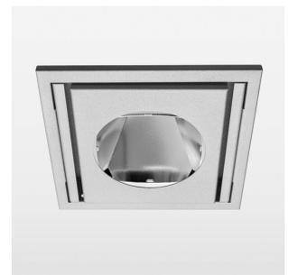
Einbauleuchte mit LED, Bemessungslebensdauer der LED L80/B10 > 50000 h, Farbwiedergabeindex CRI > 80, Farborttoleranz 3 SDCM (initial), rotationssymmetrischer Reflektor mit kreisförmigen Lichtbild, Reflektor Reinstaluminium 99,99% in MIRO-Silver®, Schwenkwinkel 30°, Leuchtgehäuse Stahlblech, pulverbeschichtet silber, separate Treibereinheit
