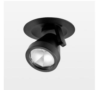
Halbeinbauleuchte mit LED, Bemessungslebensdauer der LED L80/B10 50000 h (Tambient 25°C), Farbwiedergabeindex CRI > 80, Farborttoleranz 2 SDCM (initial), Reflektor mit ovalem Lichtbild, Reflektor Reinstaluminium 99,99% in MIRO-Silver®, segmentier, Aluminium-Druckguss, pulverbeschichtet, Drehwinkel 400°, Schwenkwinkel +/- 85°, schwarz, Potentiometer zur Helligkeitseinstellung, separate Treibereinheit
