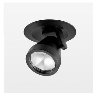
Halbeinbauleuchte mit LED, Bemessungslebensdauer der LED L80/B10 50000 h (Tambient 25°C), Farbwiedergabeindex CRI > 96, Farborttoleranz 2 SDCM (initial), Reflektor mit ovalem Lichtbild, Reflektor Reinstaluminium 99,99% in MIRO-Silver®, segmentier, Aluminium-Druckguss, pulverbeschichtet, Drehwinkel 400°, Schwenkwinkel +/- 85°, schwarz, Potentiometer zur Helligkeitseinstellung, separate Treibereinheit
