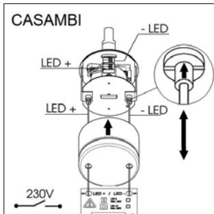
D Stromschiene und Deckenanbau: Einstellen der Seillänge und Kontaktierung der Sekundärseite
