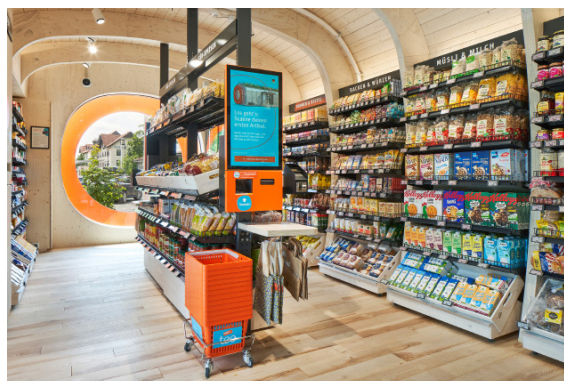
06: Die Innenbeleuchtung besteht aus zwei Komponenten: Eine warmtonige Voutenbeleuchtung oberhalb der Warenregale sowie die eigentliche Warenbeleuchtung durch Ontero IC Strahler.
